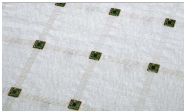
Ein Bodenbelag, der mitdenkt. Innenansicht des „thinking carpet“ Foto: Vorwerk Teppichwerke
